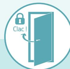
Le verrouillage de la porte s'effectue par simple fermeture de la porte sans avoir à remonter la poignée.
